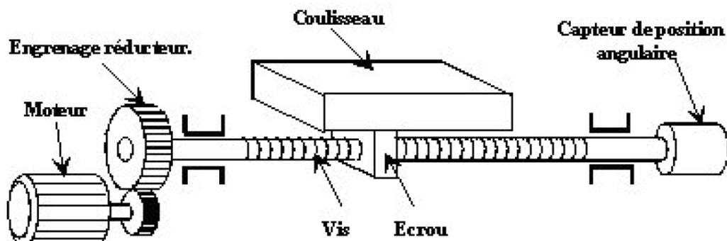
Figure 2 : Système avec encodeur absolu.
