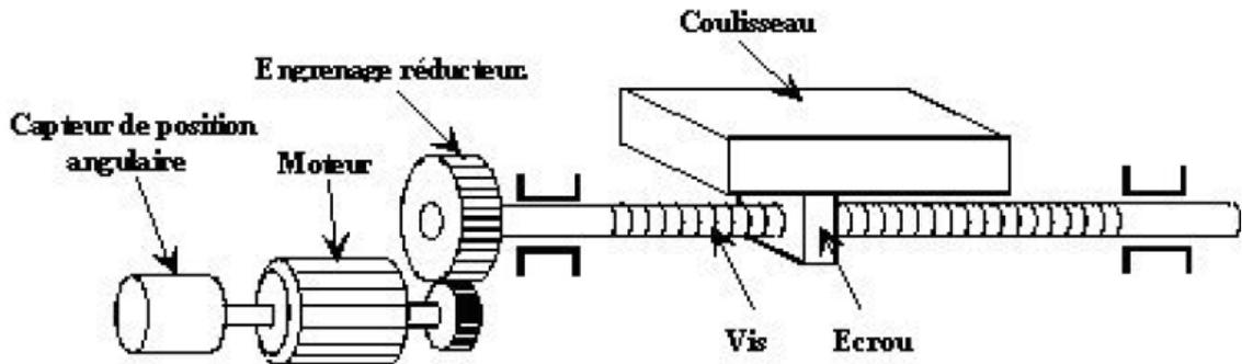
Figure 1 : Système avec encodeur incrémental.
