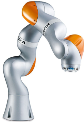
Robot redondant (iiwa, 7 DDL)
