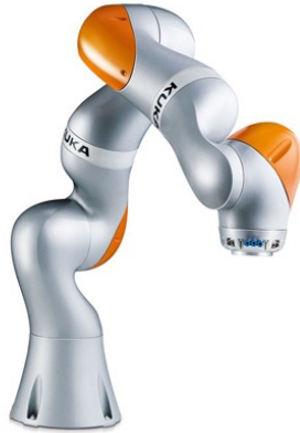
Robot redondant (iiwa, 7 DDL)
