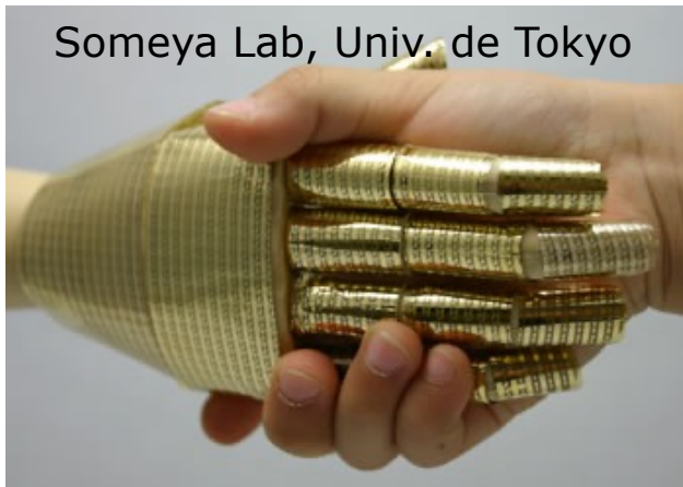
Peau flexible avec une matrice intégrée de transistors organiques
