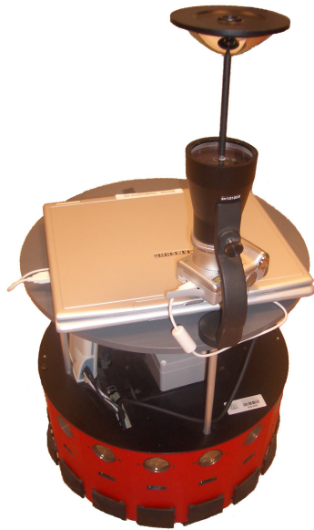
Robot avec caméra panoramique embarquée
