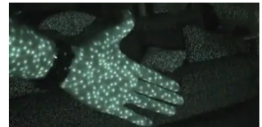
Motif IR projeté par la Kinect v1
