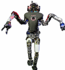
TEAM MIT Robot: Helios (Atlas) Country: USA DOB: 2013 Height: 195 cm Weight: 182 kg
