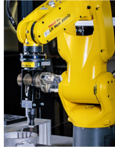
Insertion d'une bobine dans un creux non chanfreiné
