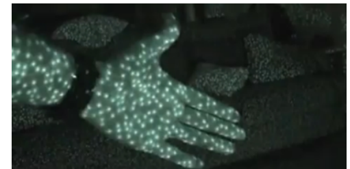
Motif IR projeté par la Kinect v1
