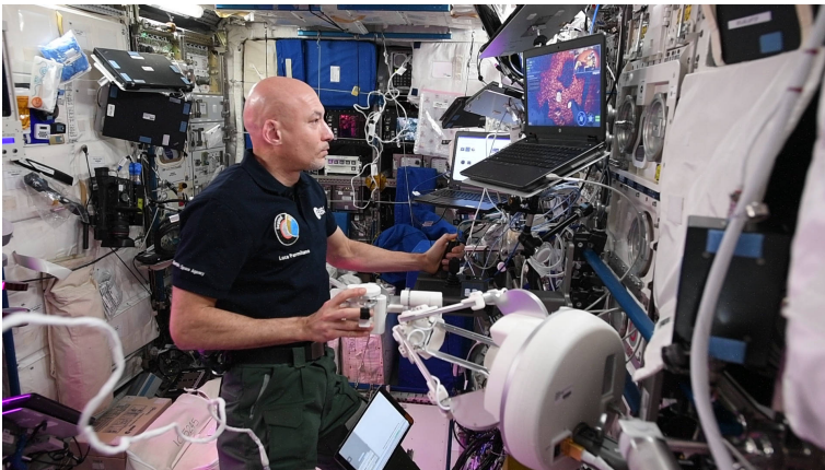
Sigma 7 de Force Dimension (7 DDL actifs) dans L'ISS (projet METERON, 2019)
