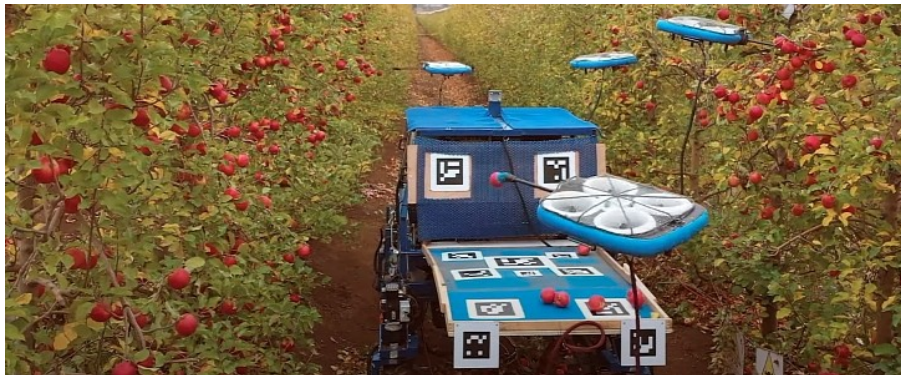
Système autonome (drones + véhicule à roues) de Tevel (Israël)
