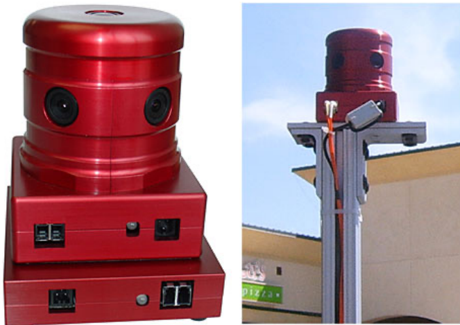
Ladybug de Point Grey (0.8 Mpixels \times 6 caméras)
