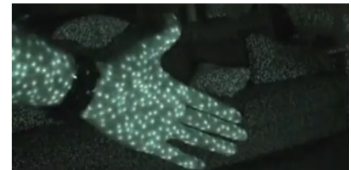
Motif IR projeté par la Kinect v1
