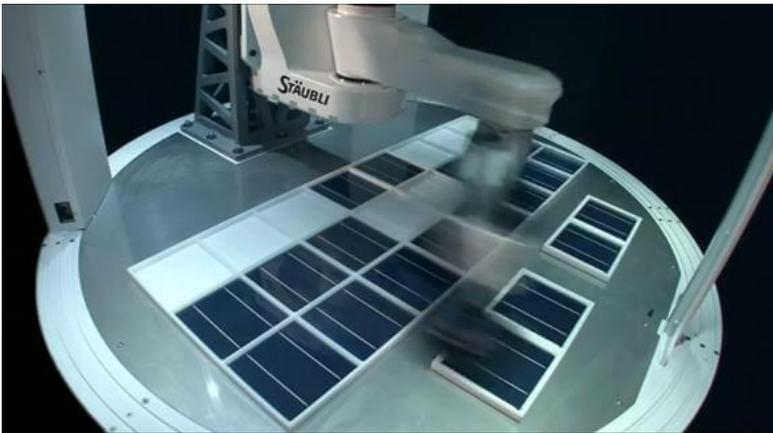
Le robot *TP80 Fast Picker* de Staubli peut saisir 200 objets/min (objets d'un poids inférieur à 1 Kg)
