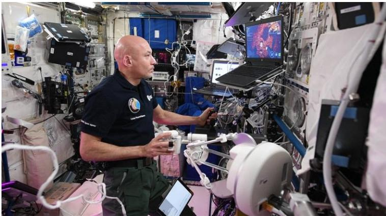
Sigma 7 de *Force Dimension* (7 DDL actifs) dans L'ISS (projet METERON, 2019)
