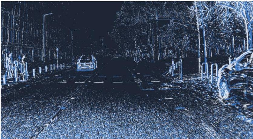
“Image événementielle” acquise par la caméra EVK3 embarquée sur un véhicule en mouvement
