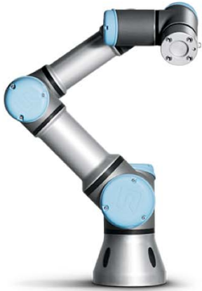
Robot non redondant (UR3, 6 DDL)
