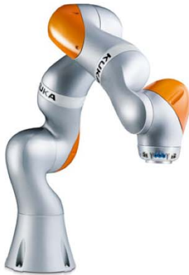
Robot redondant (LBR iiwa, 7 DDL)
