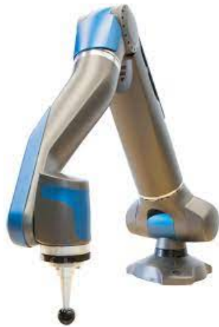
Robot redondant (DLR SARA, 7 DDL)
