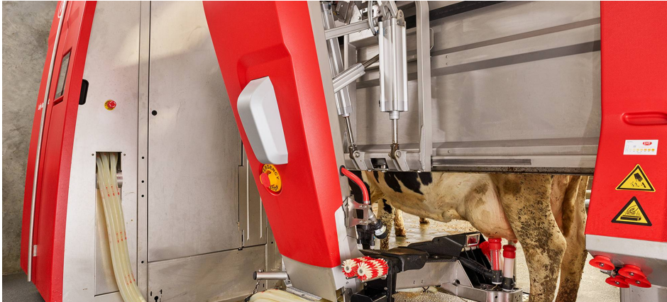
Traite robotisée ( Astronaut A5 de Lely)
