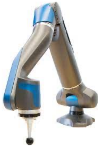
Robot redondant (DLR SARA, 7 DDL)
