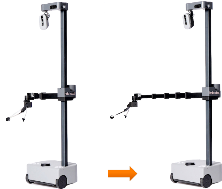
Plateforme mobile avec bras télescopique à usage domestique ( Stretch 3 de Hello Robot)
