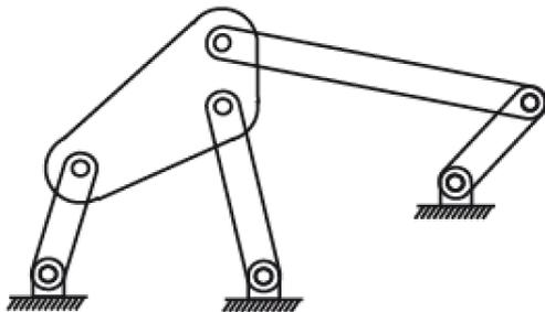
6) Mécanisme de Watt (6 corps)
