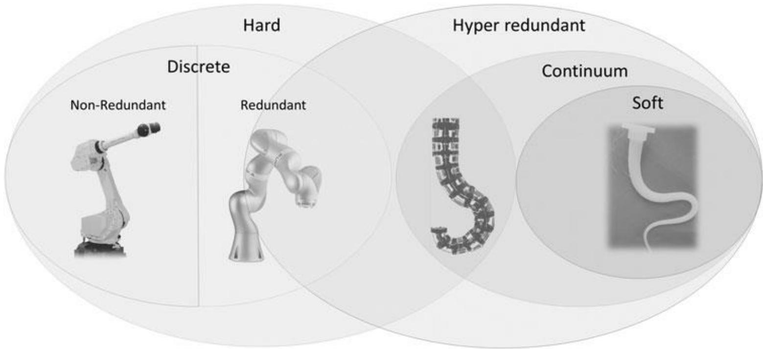
**Évolution des manipulateurs** : de robots avec segments rigides basés sur mécanismes discrets à des robots bio-inspirés basés sur structures flexibles
