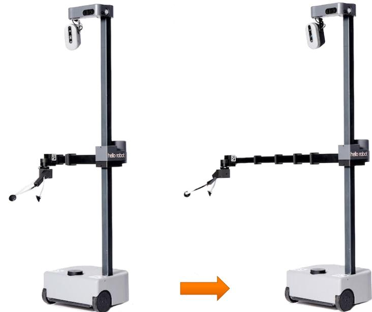
Plateforme mobile avec bras télescopique à usage domestique (*Stretch 3* de Hello Robot)
