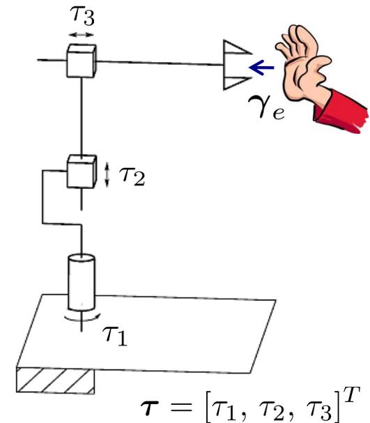
La **transposée du jacobien géométrique** d'un manipulateur met donc en relation les forces sur l'effecteur avec les forces sur les  $n$  articulations
