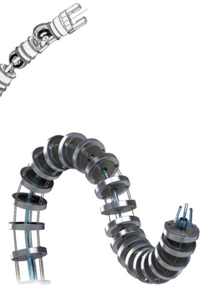
Robot continuum (nombre infini de DDL)
