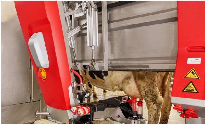
Traite robotisée ( Astronaut A5 de Lely)
