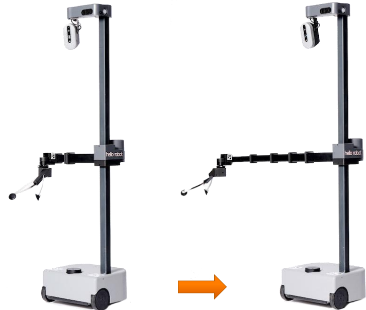
Plateforme mobile avec bras télescopique à usage domestique ( Stretch 3 de Hello Robot) https://hello-robot.com
