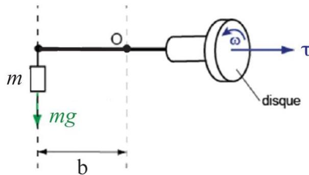
Figure 3 : Gyroscopie mécanique.
