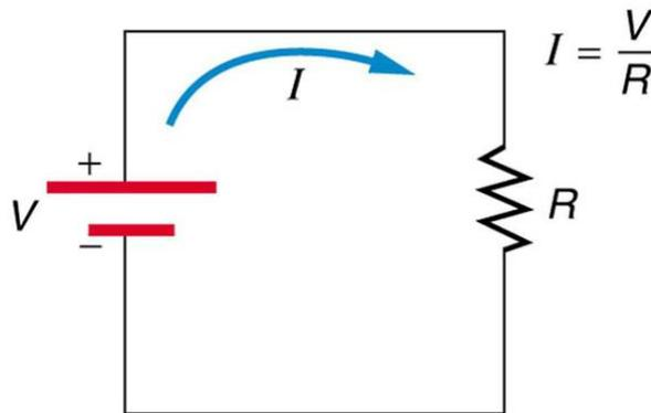
**Figure 1 :** Résistance traversée par un courant.
