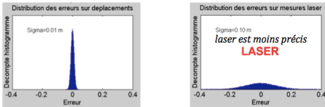
Figure 3 : (à gauche) incertitude de l'odométrie,  $\sigma_{odom} = 0.01$  m; (à droite) incertitude du capteur laser,  $\sigma_{laser} = 0.1$  m.
