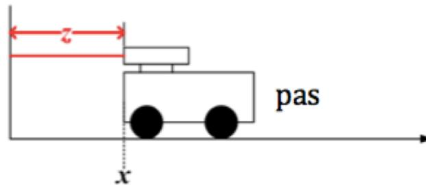
Figure 2 : Chariot à deux roues encodeuses avançant d'un pas, avec laser embarqué.
