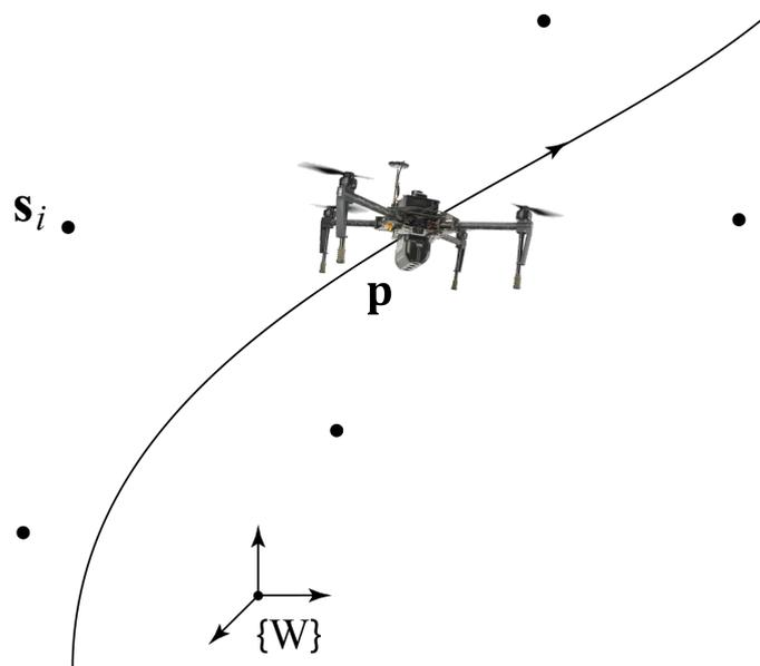
**Figure 4** : Localisation d'un drone à partir des mesures de distance de  $n$  balises de position connue  $\mathbf{s}_i$  (points noirs).
