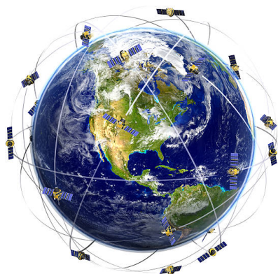
Réseau de satellites GPS (numéro minimum de satellites pour une constellation complète: 24, opérationnels 95% du temps)
